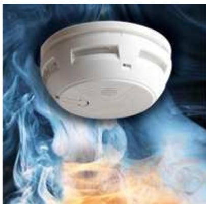
Le rôle du détecteur normalisé de fumée n'est autre que d'alerter à temps les occupants du logement lors d'un départ de feu. En cas d'émanation de fumée, le détecteur émet un signal sonore suffisant pour réveiller une personne endormie (85 dB à 3 m). Ce dispositif est loin d'être anodin : il permet a priori de réduire de 90 % le risque de décès en cas d'incendie.
