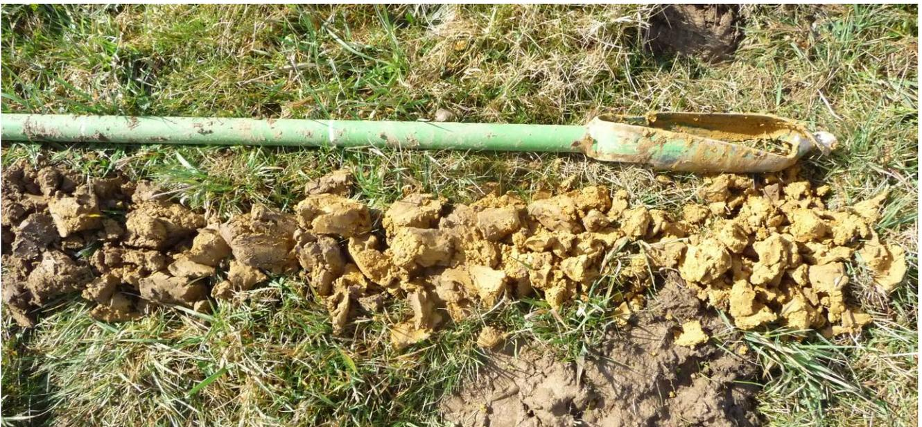
Profil pédologique « non humide » (sondage 9-3) où des marques d'hydromorphie (traits rédoxiques de couleur rouille) apparaissent entre 25 et 50 cm de profondeur et se poursuivent en profondeur, et aucun trait réductique (« gley » gris ou gris-bleu) n'apparaît entre 80 et 120 cm, où l'argile devient sablonneux et de couleur jaunâtre.
