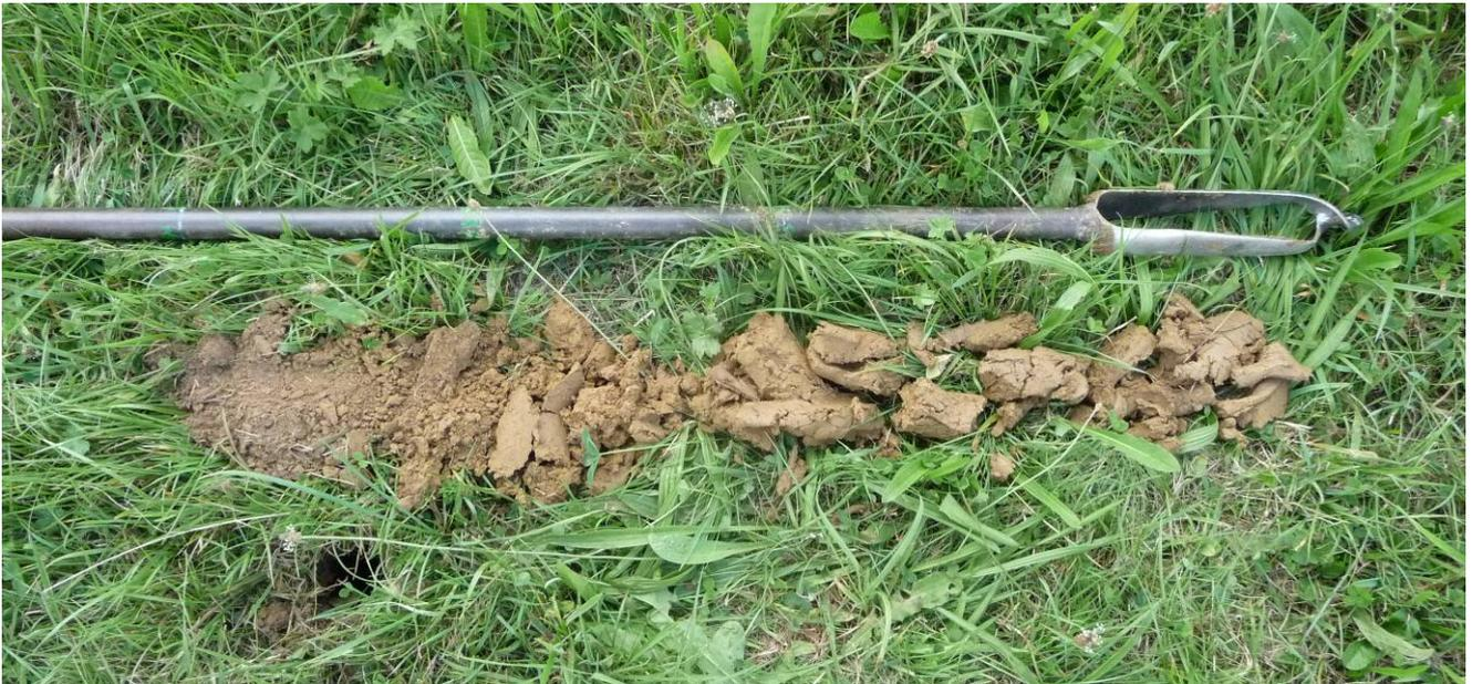
Profil pédologique « humide » (sondage 1-4) où des marques d'hydromorphie (traits rédoxiques de couleur rouille) apparaissent entre 25 et 50 cm de profondeur et se poursuivent en profondeur, et un trait réductique (« gley » gris ou gris-bleu) apparaît entre 80 et 120 cm.
